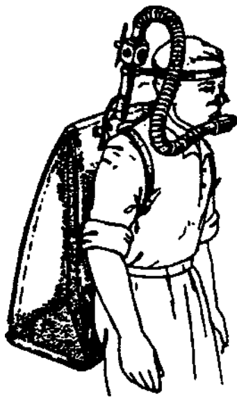
Şəkil 5. Duqlas kisəsi ilə oksigen qazının miqdarının təyini.
